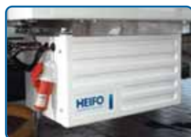
Zestaw stand-by dla chłodzenia postojowego
